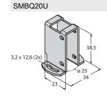
Защитный корпус, нерж. сталь, для серии Q20
