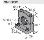
3052521 Монтажный зажим, РВТ черн., для датчиков с резьбой 30 мм, поворотный
