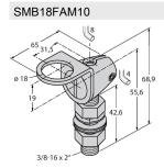
3011184 Монтажный кронштейн, VA 1.4401, для резьбы M10 x 1.5, длина резьбы 18 мм
