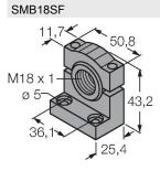
Монтажный зажим, РВТ черн., для датчиков с резьбой 18 мм, поворотный
