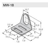
6945004 Монтажный кронштейн для цилиндрических резьбовых датчиков; материал: Нержавеющая сталь A2 1.4301 (AISI 304) SMB18A
