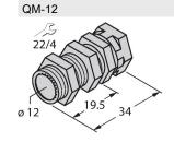
Зажим-фиксатор для быстрой установки; материал: Хромированная латунь. Наружная резьба М16 × 1. Примечание. При использовании кронштейнов для быстрого монтажа дистанция переключения датчиков приближения может меняться.
