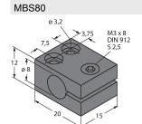
Монтажный зажим для цилиндрических гладких датчиков; материал монтажного блока: Анодированный алюминий
