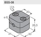
Монтажный зажим для цилиндрических гладких и резьбовых датчиков; материал: Полипропилен
